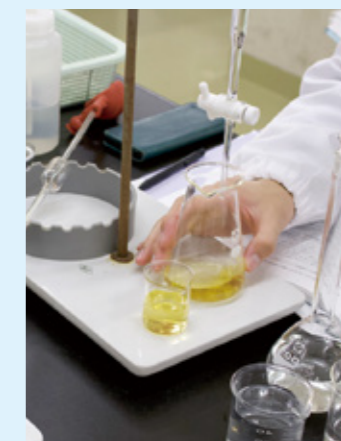
ビュレットを用いた滴定操作の様子
