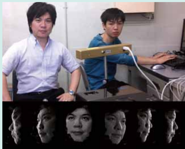
開発中の顔認証システムの実験風景。顔の立体形状を測定中
