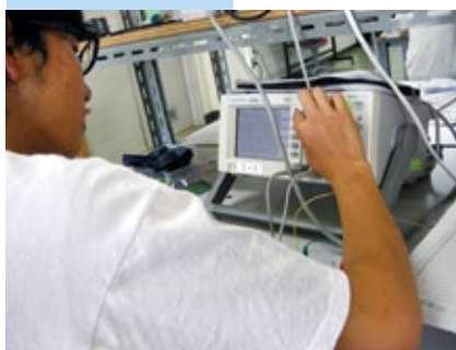
シロスコープによる作成物の測定の様子 正常に動作しているかどうか波形によって判断します
