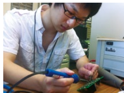
回路作成の様子 半田ゴテを用いてハンダ付けを行います
