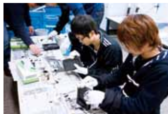
〈雨畑硯〉原石から手彫りで削った硯の仕上げ作業をしています。
