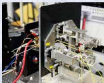
光学プローブを用いた ガス拡散層内部の酸素分圧測定
