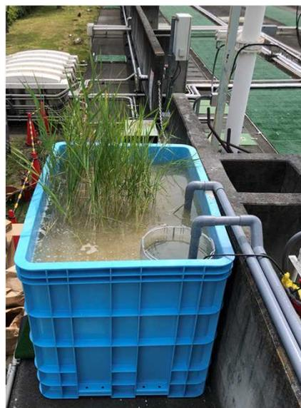
人工湿地による下水処理の実証試験の様子
