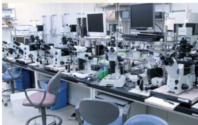
図2. マイクロマニピュレーター 当施設には12台のマイクロマニピュレーターが完備され、世界でここでもしか出来ない実験も行われています。
